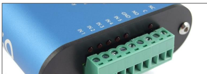
obr. 20 – řada kontrolky nad svorkami
